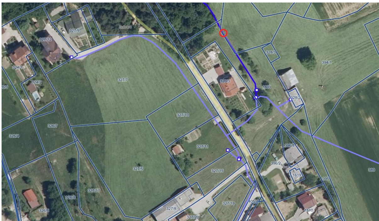
Slika 17: Prikaz mesta priključitve na vodovodno omrežje
