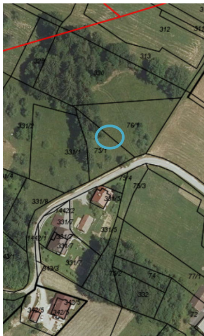
Slika 9: Prikaz energetske infrastrukture v bližini obravnavanega območja, kjer je z rdečo prikazan prostozačni sredjenapetostni daljnovod (Vir: https://gis.iobcina.si/gisapp/Default.aspx?a=zrece , januar 2021)
